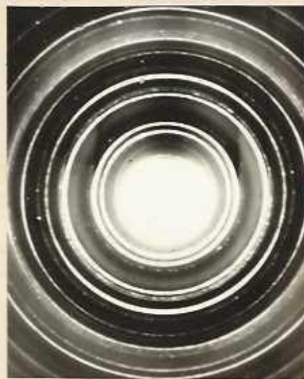
Рис. 1.3. Электрограмма от капельной фазы олова при 450^{\circ}\text{C} после воздействия торсионным излучением в течение 6 минут с правовинтовой ориентацией - а, электрограмма той же фазы после обработки излучением с левовинтовой ориентацией - б.
