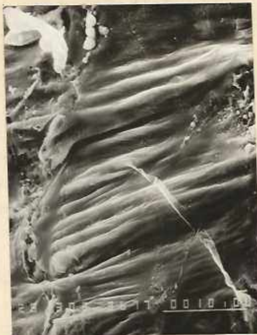
Рис. I.7. Поверхность олова при температуре 500°C; x4500.
