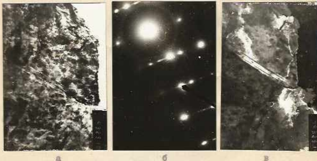
Рис. 2.3. Субструктура облученной меди - а; ее электронограмма - б и темнопольное изображение двойника в рефлексе, указанным стрелкой на электронограмме - в; а, в - \times 19000 .
