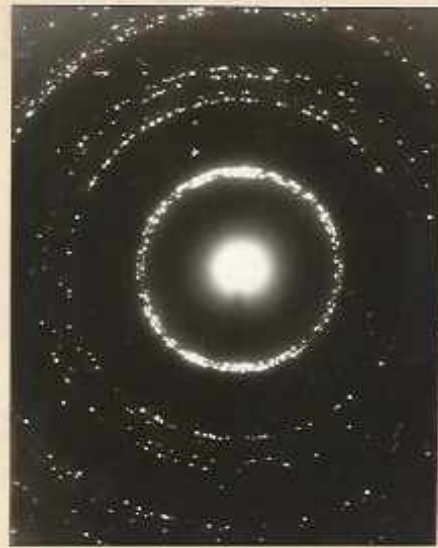
Рис.1.1. Конденсированная пленка олова толщиной 300 Å на графитовой подложке, \times 10000 - а и ее электронограмма - б.
