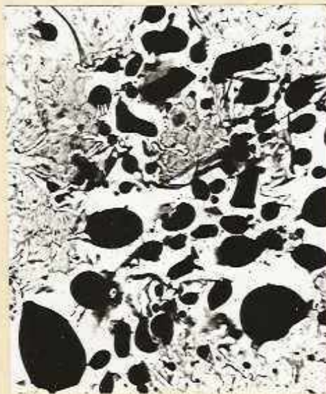
Рис.1.2. Изображение той же пленки при 450^{\circ}\text{C} , \times 10000 - а и электронограмма от капельной фазы - б.
