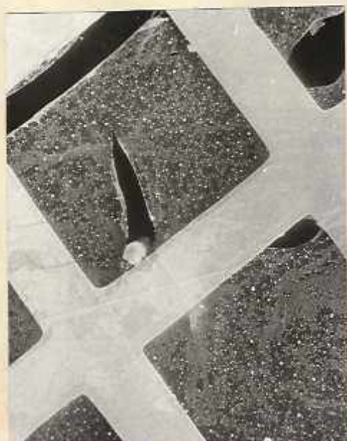
Рис.1.6. Растровое изображение образца олова на графитовой подложке и медной сетке, \times 40 - а и отдельных частиц, \times 7200 - б.
