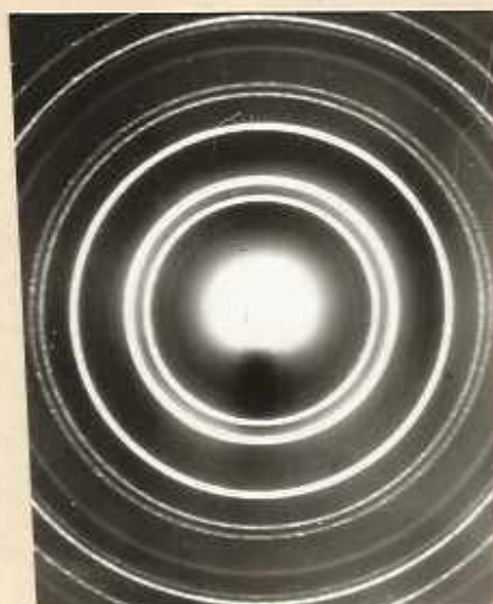
Рис. 1.3. Электрограмма от капельной фазы олова при 450^{\circ}\text{C} после воздействия торсионным излучением в течение 6 минут с правовинтовой ориентацией - а, электрограмма той же фазы после обработки излучением с левовинтовой ориентацией - б.
