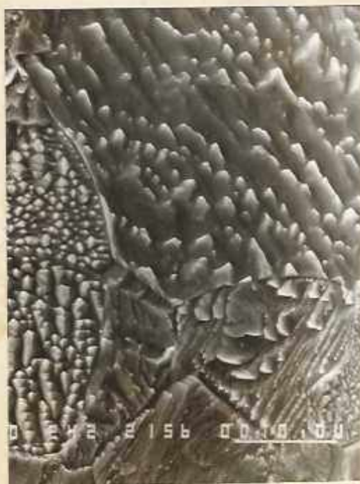
Рис. I.8. Микроструктура цилиндрической пробы затвердевшего олова, отобранного из расплава при температуре 400°C, x 3600.
