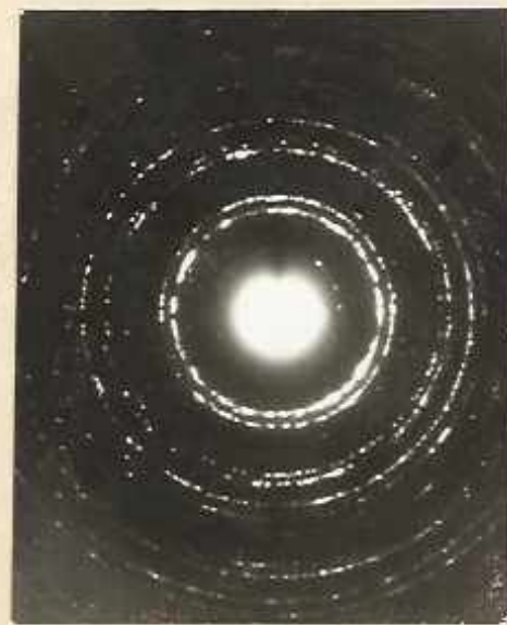
Рис.1.2. Изображение той же пленки при 450^{\circ}\text{C} , \times 10000 - а и электронограмма от капельной фазы - б.
