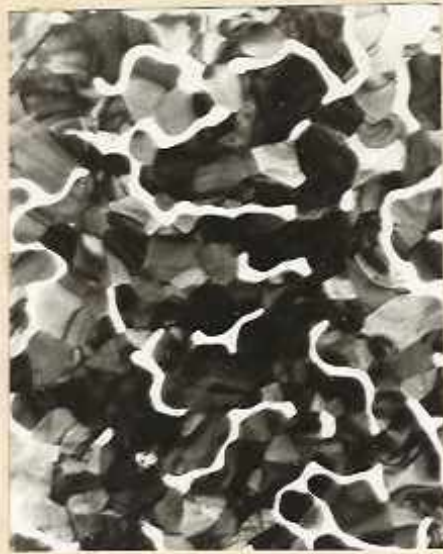
Рис.1.1. Конденсированная пленка олова толщиной 300 Å на графитовой подложке, \times 10000 - а и ее электронограмма - б.
